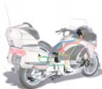
De regelenheid van het BMW Motorrad Integral ABS (volledig integraal) en de drukmodulator garanderen veilig en snel tot stilstand komen en een goede doseerbaarheid van de remkracht.
